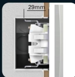
Nožice omogućavaju dublje pričvršćivanje (i preko keramičkih pločica i sl.)
